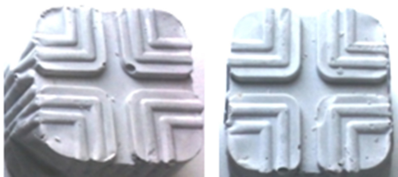
Fig.20. Modificarea de culoare la o stucatura netratata (stanga) si tratata (dreapta)
