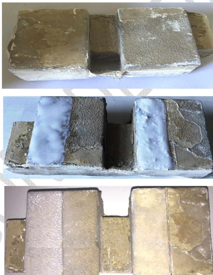
Figura 1. Imagini ale stucaturii studiate: de sus in jos: netratata, aplicarea tratamentului si dupa tratament
