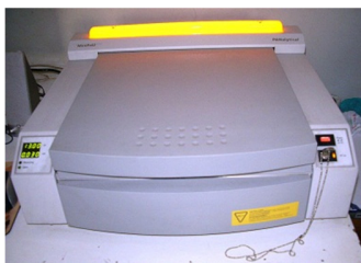
Figura 4. (EDXRF), Mini Pal 2, PANalytical
